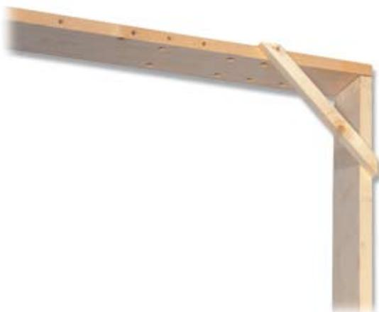
La prima fase di messa in opera del control telaio consiste nella giunzione nella parte alta dell'asse laterale con quella trasversale.
